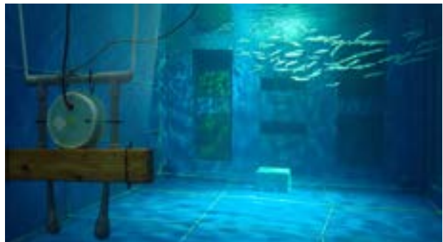
水中音が、スルメイカの群れ行動に与える影響を調査する実験の様子
